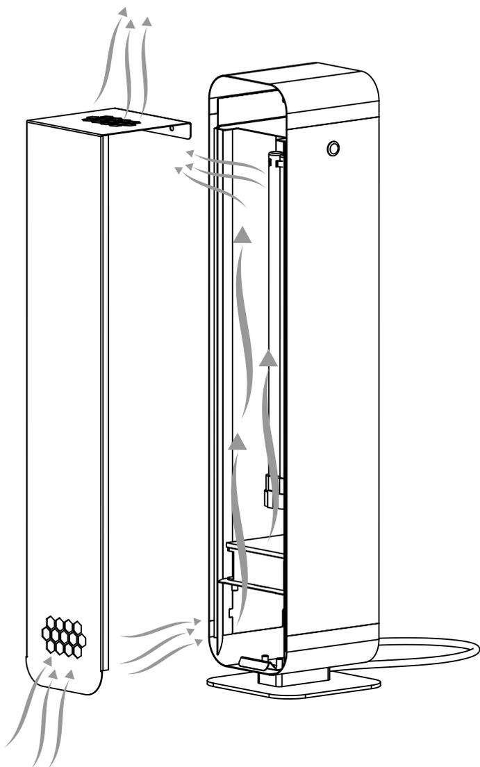
Lampy przepływowe UV-C STERILON FLOW
