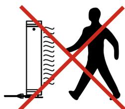
После включения светильника УФ-С STERILON FLOW **нельзя** оставаться в помещении, в котором он работает. Во время его включения/выключения **необходимо** использовать защитные очки и иметь на себе одежду с длинными рукавами и защитными перчатками.
